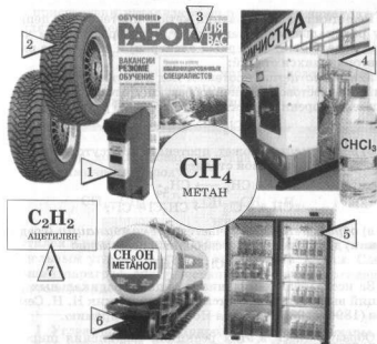
Рис. 13. Применение метана: 1—3 — производство сажи (картриджи 1, резина 2, типографская краска 3); 4—7 — получение органических соединений (растворителей 4, хладагентов (фреон), используемых в холодильных установках, 5, метанола 6, ацетилена 7)
