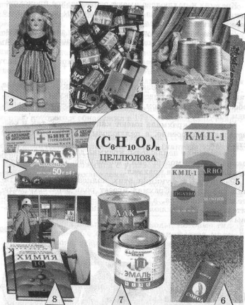
Рис. 72. Применение целлюлозы: 1 — вата, марля и бинты; 2 — пластмасса (целлулоид); 3 — фотопленка; 4 — искусственные волокна и ткани; 5 — клей; 6 — порошок; 7 — эмали и лаки; 8 — бумага и изделия из нее
