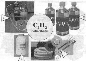
Рис. 24. Применение ацетилена: 1 — резка и сварка металлов; 2—4 — производство органических соединений (растворителей 2, поливинилхлорида 3, клей 4)
